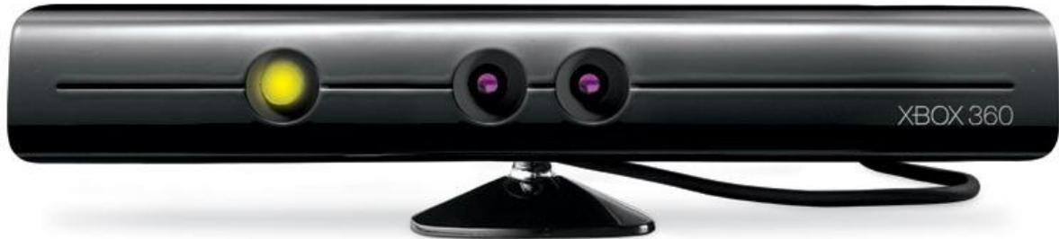
그 동안의 실시간 3차원 공간 측정 기술은 초음파나 레이저 등 고가의 장비로만 구현할 수 있어 그 범용적인 활용에 많은 제한이 있었다. 그러나 2010년 마이크로소프트社에서 Kinect를 발매한 이후, 100달러가 조금 넘는 이 하드웨어만으로도 정밀도가 높은 3차원 공간 인식이 가능해졌다. 차세대 콘솔 게임기인 XBOX360의 인체 제스처 인식용 컨트롤러로 개발된 Kinect는 최근 PC 버전 하드웨어와 함께 SDK (Software Development Kit)가 출시되어 다양한 분야에서 본격적인 활용이 시작되고 있다. 본 연구주제는 마이크로소프트의 Kinect를 활용하여, 제스처 기반 사용자 인터페이스 제작, 로봇 자율 주행 시스템, 3차원 전신 스캐너 등 기계공학의 다양한 분야에 활용하는 방법을 학습한다.
