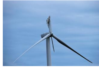
(a) 풍력발전기 블레이드 파손 (b) 헬리콥터 추락 그림 1: 로터 파손에 의한 피해
