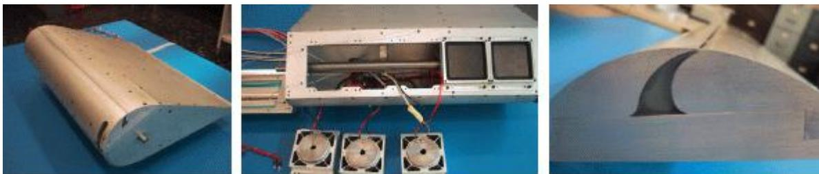
그림 2 XV-15 풍동 실험에 사용된 유동제어 모듈 및 실험 장치
