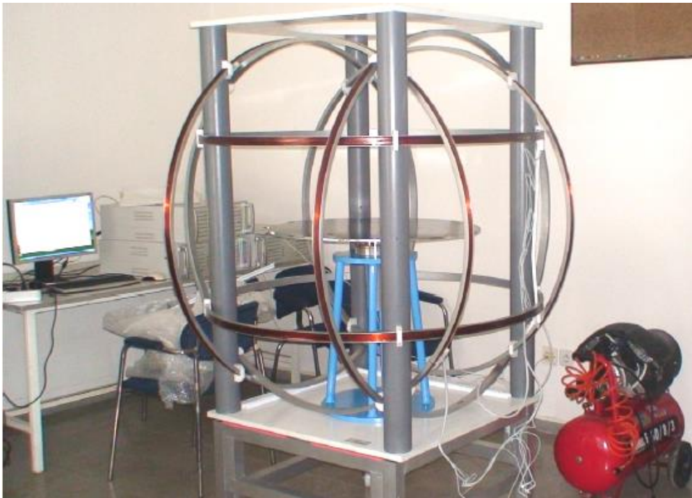
큐브위성 자세제어 Hardware In the Loop 시뮬레이션을 위한 Helmholtz Coil 예시
