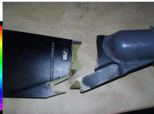
그림 2. 반복하중 시험으로 손상된 블레이드
